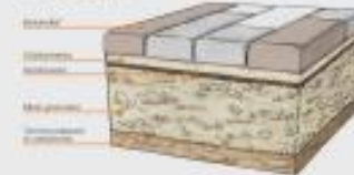
DETTAGLIO AUTOBLOCCANTI - TIPO "LISTONE"
