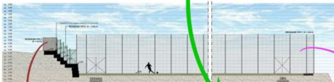
PROSPETTO RECINZIONI SU SEZIONE GENERALE G-G' scala 1:200
